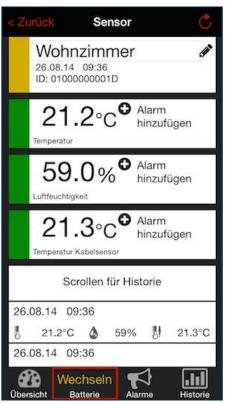
Wenn es erforderlich ist, dass die Batterie des Sensors gewechselt werden muss, wird der betreffende Sensor in der Übersicht mit einem gelben Feld dargestellt. Zusätzlich wird der Status der Batterie mit "Wechseln" gekennzeichnet.
