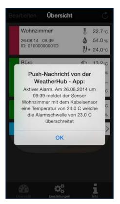
Ein Sensor wird mit einem roten Feld angezeigt, wenn bei einem oder mehreren Messwerten des Sensors ein aktiver Alarm ansteht.
