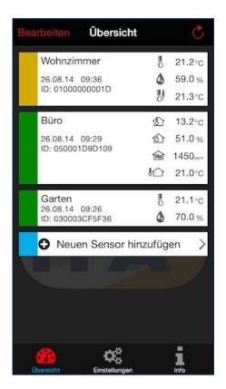
Ein Sensor wird mit einem gelben Feld angezeigt, wenn die Batterie des Sensors gewechselt werden muss oder wenn der Server seit 15 Minuten keine Daten mehr vom betreffenden Sensor empfangen hat.
