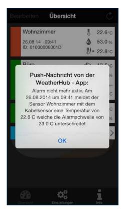
Wurde aufgrund der Alarmeinstellungen des Sensors ein Alarm ausgelöst und die Alarmbedingung ist nach dem letzten Update der Sensor-Daten nicht mehr erfüllt (Messdaten sind wieder im normalen Bereich), wird der betreffende Sensor mit einem orangenen Feld dargestellt.
